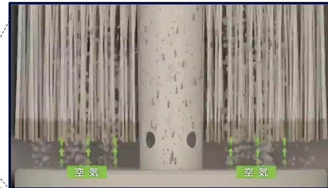
独自開発した世界中でクラレしかない中空糸膜とモジュール構造が高濁度耐性を実現
