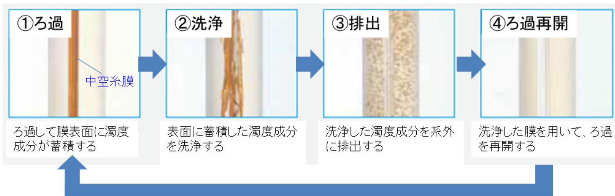
高濁度に対応するためには、ろ過で蓄積した濁度成分を洗浄によってモジュール内部から十分に洗浄・排出することが重要
